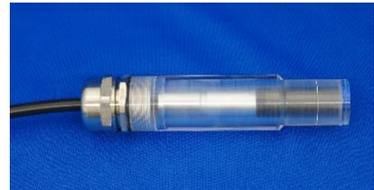
中線量率測定用電離箱C-110(6ml)を防水型ビルドアップキャップに入れた状態
