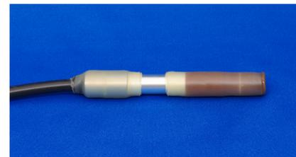
大線量率測定用電離箱電離箱C-111F(0.24ml)短縮型に防水シールをした状態
