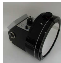
70 μm線量当量測定状態
